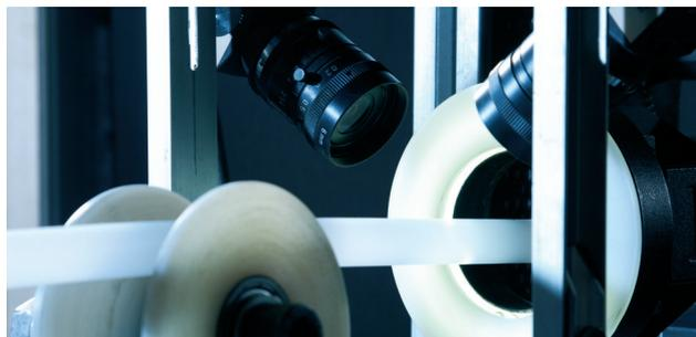
**Инструментальный контроль** (контроль толщины стенки вне линии экструдера)
